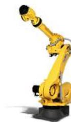
**19** Grâce aux capteurs de couple sensibles incorporés dans chacune de ses articulations, le robot est capable de contrôler l'effort ou la sensibilité appliquée selon les cas d'applications.
